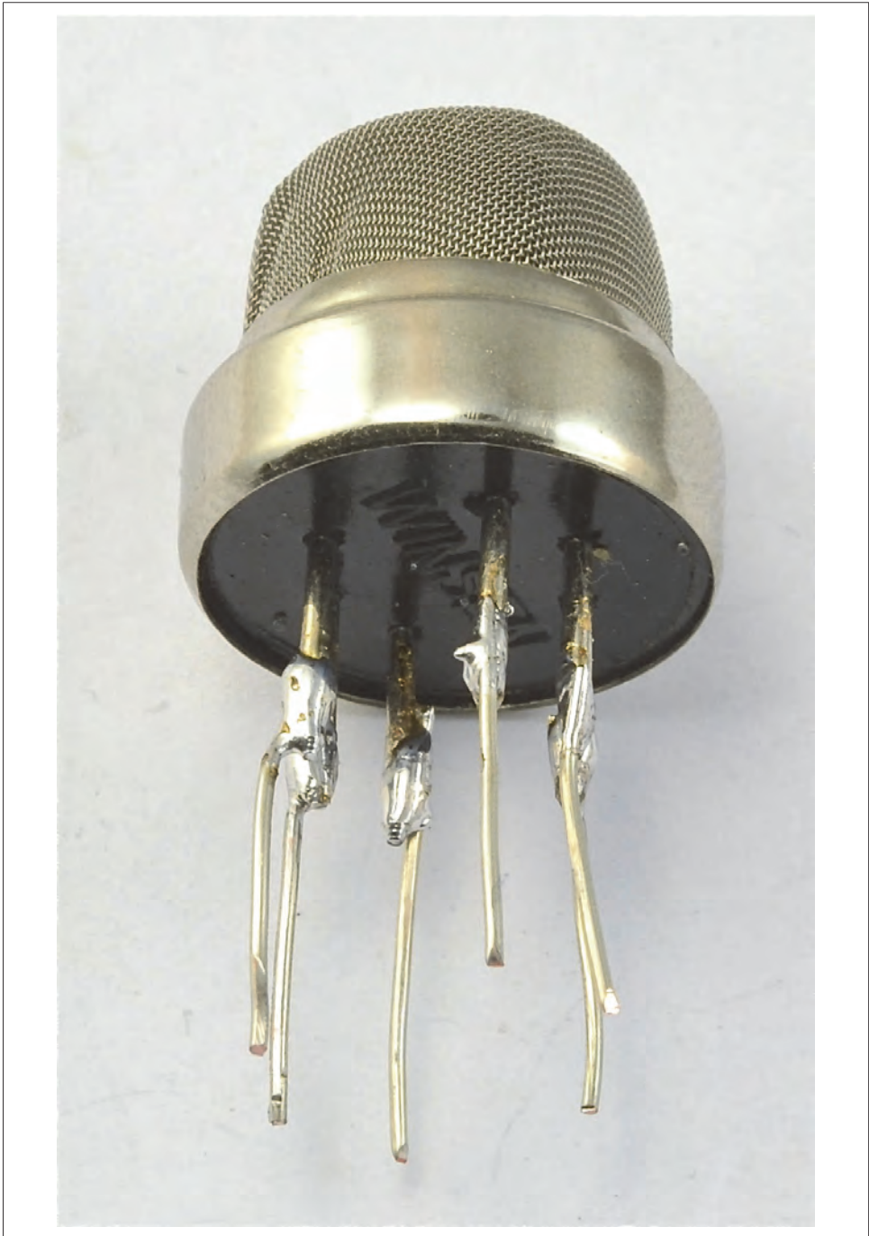
Figura 13.7. Cables de soldadura en el sensor de gas.
