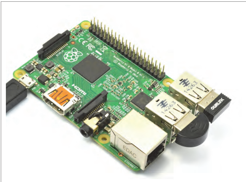
Figura 1.17. Raspberry Pi 2 con adaptadores USB para bluetooth y wifi .
