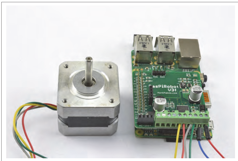
Figura 11.16. Utilizar una tarjeta RaspiRobot para controlar un motor paso a paso bipolar.
